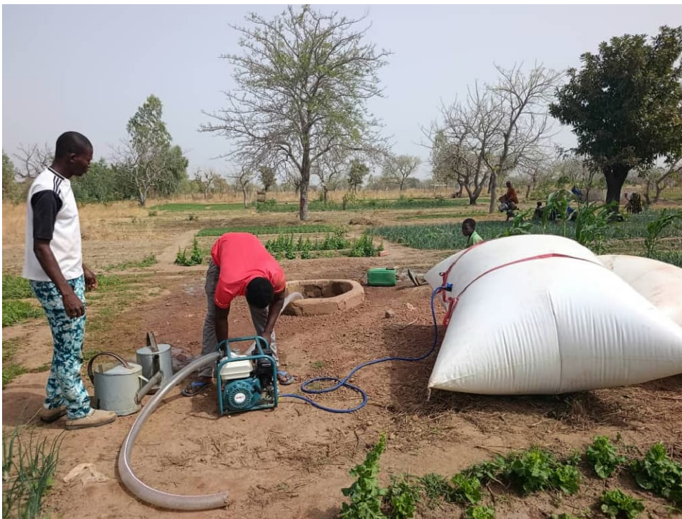
Abbildung 11: Anwendung des Biogases für die Bewässerung mit einer Wasserpumpe an einem Brunnen
